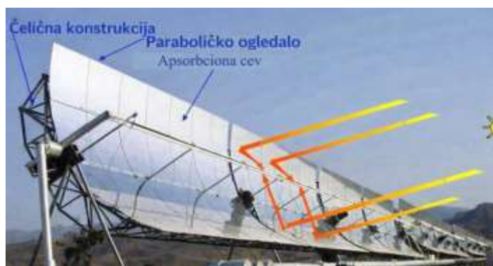
Slika 3.12. Princip solarnog kolektora sa paraboličnim koritom [64]
